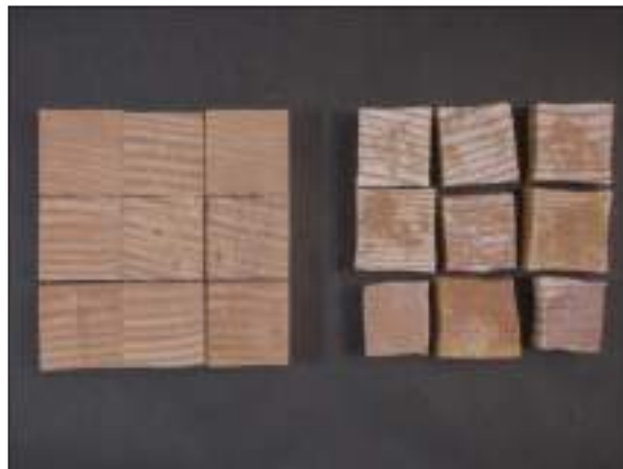
試驗結束後的木片 (左：Marvel Wood / 右：未處理的試驗體)
