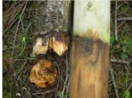
木樁破損處放大後 左：破損的未處理木材 右：Marvel Wood
