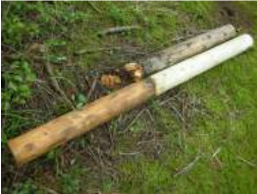
試驗開始後第 2 年的試驗木樁模樣 上方：破損的未處理木材 下方：Marvel Wood
