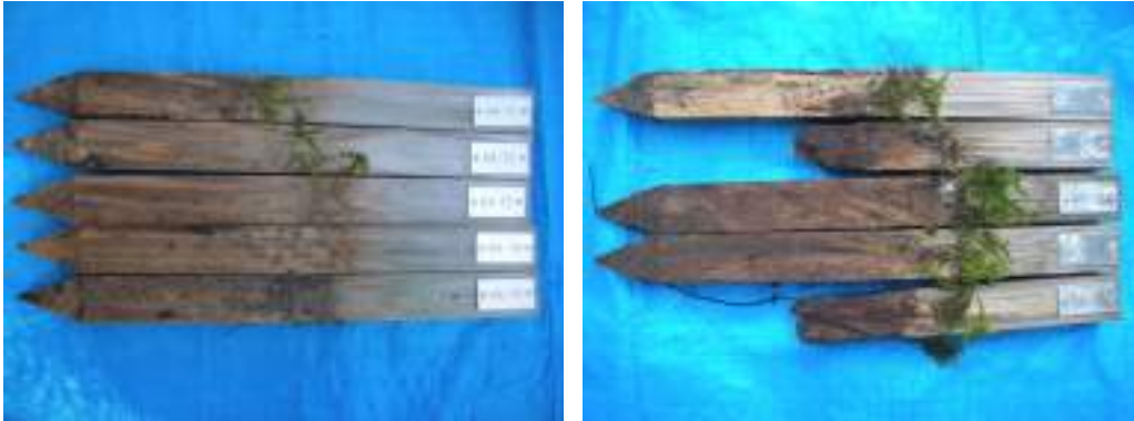
試驗結束時的試驗體（左：Marvel Wood／右：未處理的試驗體）
