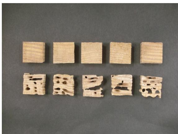
試験終了後の木片（上段：マーベルウッド、下段：無処理試験体）
