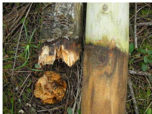
杭の破損箇所の拡大
