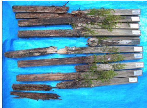
無処理試験体（試験開始 3 年目時点）
