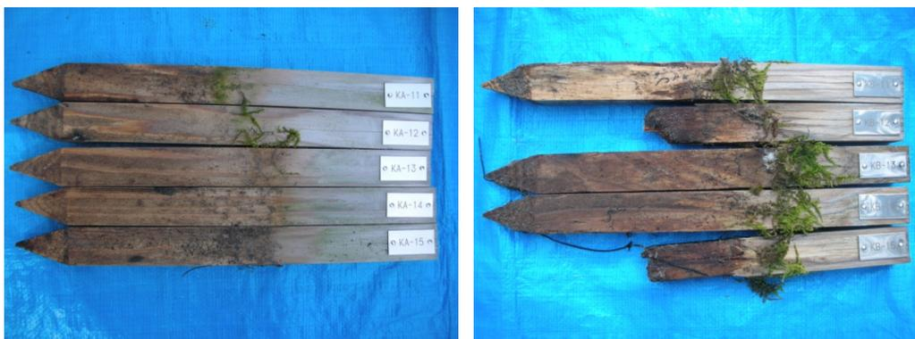
試験終了時の試験体(左：マーベルウッド、右：無処理試験体)
