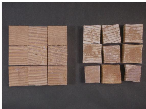
試験終了後の木片（左：マーベルウッド、右：無処理試験体）
