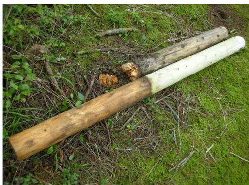
試験開始2年時点の試験杭の様子
