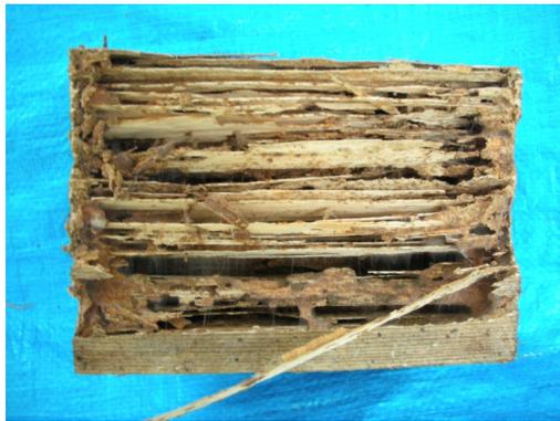
ベイツガ無処理材の被害例
